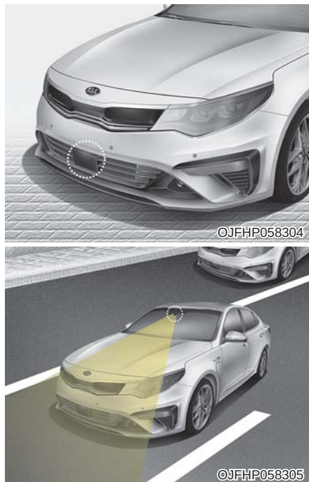
■ 차간거리 감지 센서(전방 레이더/전방 카메라) 전방의 차량을 감지하여 차간거리를 유지시켜 주는 센서입니다.
