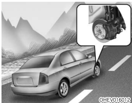
2. 밀림방지장치 작동 (유압 LINE 강제 닫힘)
